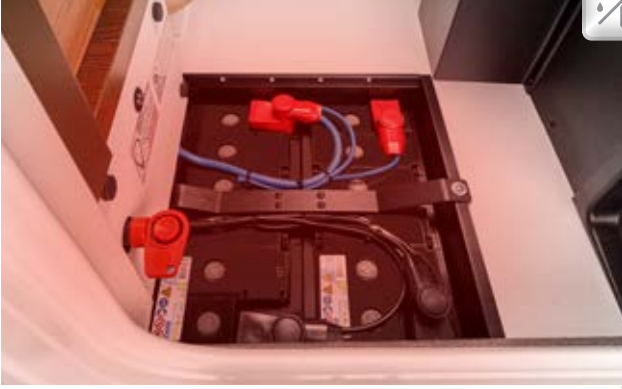
Batterisentral oppvarmet med hovedstrøbyter. standard: 2 x 80 Ah gelbatterier, lett tilgjengelig i utvendig lasterom plassert på passasjersiden, 90 Ah Li-Ion-batteri som tilvalg, inkludert battericomputer og separat touch-display
