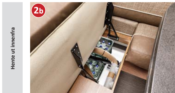
Lettvent uttak av innholdet i oppbevaringsrommet innenfra ved å vippe opp setet på seteбенken i L-sittegruppen med patentbeslag
