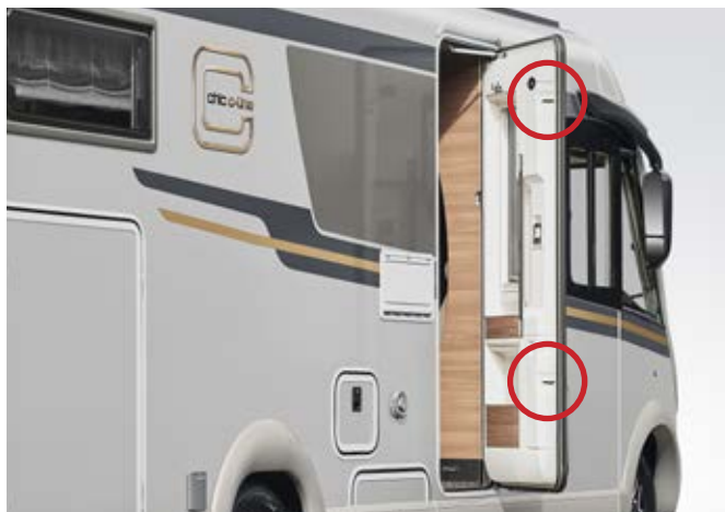
med bredere døråpning (63 cm), dobbel sikkerhetslås, ekstra bredt dørvindu, mørkleggingsgardin og integrert rullegardin med insektnett
