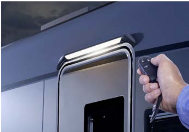
Med fjernkontroll i hovednøkkel for samtidig aktivering av sentrallås og utvendig belysning
