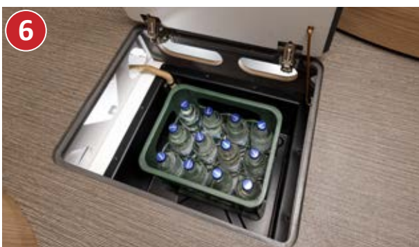
Luke i bodelsgulvet med lasterom i dobbeltgulvet (nyttbar høyde 42 cm), i oppvarmet dobbeltgulv
