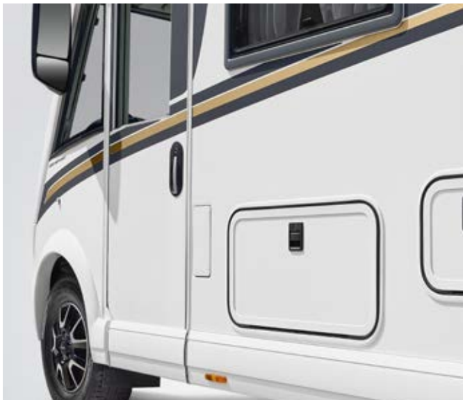
med skjulte hengsler – integrert i plan med karosseriet
