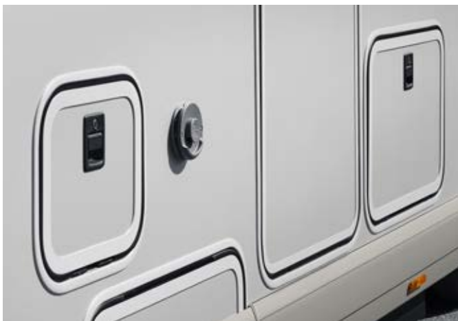
med skjulte hengsler – integrert i plan med karosseriet
