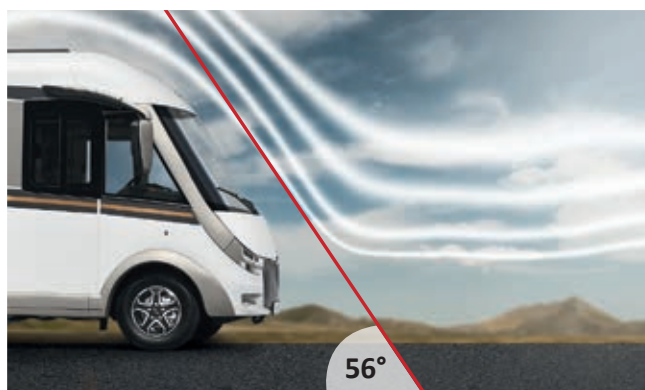
Tredimensjonalt utformet front, flat innfallsvinkel for mindre luftmotstand, reduksjon av drivstofforbruket og mindre vindstøy
