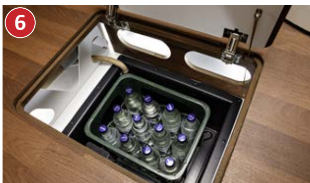
Oppbevaringsluke med lasterom i dobbeltgulvet (nyttbar høyde 42 cm) i oppvarmet dobbeltgulv
