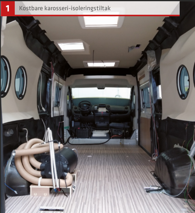
2 Kuldebrofritt kledde sidevegger og karosseribjelker
