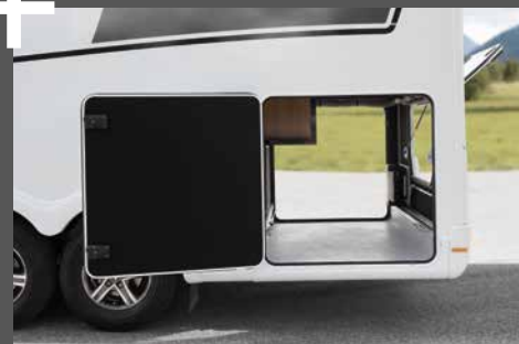
Stor garasje bak til transport av u håndterlig feriebagasje. Leveres som standard med to luker
