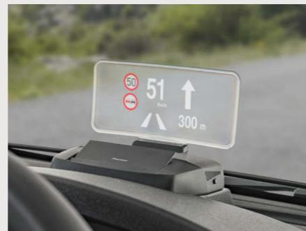
**Det integrerte head-up-displayet** sørger for mer sikkerhet. Alle relevante data, for eksempel anvisningene fra Pioneer-navigasjonssystemet, projiseres direkte i synsfeltet ditt (ekstrautstyr).
