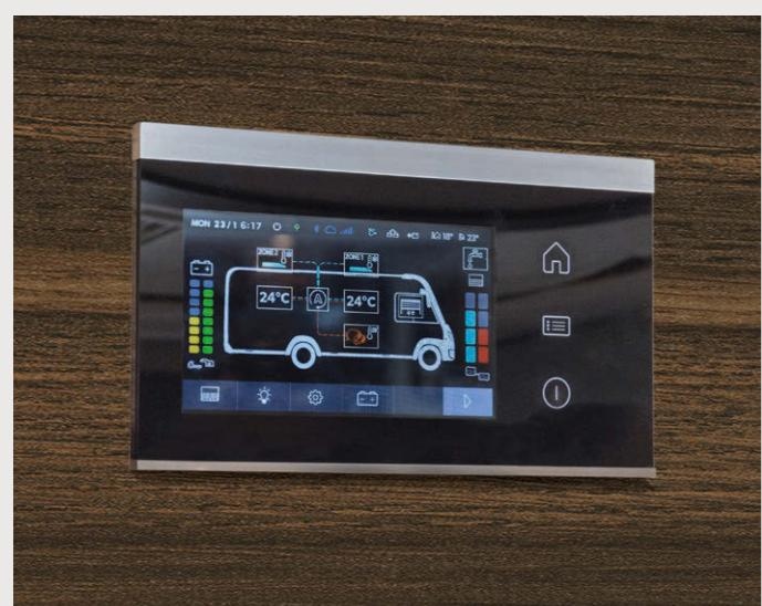
**Moderne teknologi.** Med KNAUS smart CI er den sentrale kontrollen av de tekniske enhetene spesielt enkel og brukervennlig. Vår 4,3 tommers berøringsskjerm er den mest komfortable og lette måten å kontrollere alle sentrale funksjoner i kjøretøyet på. Den kan betjes ved å berøre skjermen, omrent som en smarttelefon. Slik har du raskt en oversikt over temperatur eller fyllingsnivå i kjøretøyet (modellavhengig/ekstrautstyr).
