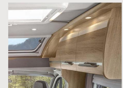
**Stabilt og nøyaktig.** Med en forsegjort pluggteknikk oppnår vi et høyt nøyaktighetsnivå og en mye mer stabil møbelkonstruksjon. Dessuten bruker vi massive aluminiumsprofiler som ikke bare gjør møblene mer stabile, men også lettere (modellavhengig).
