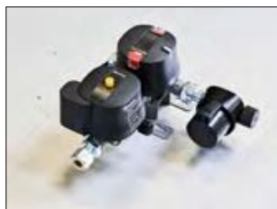
Duo Control. Duo Control har innebygd automatisk gassomkopler, reduksjonsventil og kollisjonssensor som utløses ved sammenstøt med en G-kraft på 3,5 G. Gasstilførselen stenges da av med en gang for å unngå gasslekkasje. Duo Control er godkjent i hele Europa for å ha gassen tilkoplest under kjøring.
