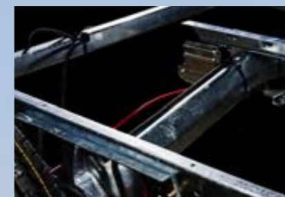
Ekstra vridningsstivt chassis. Ekstra bjelker mellom langsgående chassisrammer gir mer stabilt gulv og ekstra vridningsstivt chassis. Mellombjelker for beste stabilitet. Chassiset har utstikkere fra langsgående sidebjelke for å avlaste tyngden der gulv og vegg er sammenføyd. Karosseriet tåler veldig høy belastning, for eksempel når store mengder snø ligger på taket.
