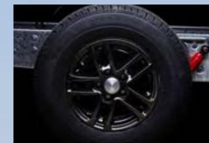
Dekkene og koplingen. Dekk på enkeltakslede vogner er av typen 8-lags dekk. 14" platefelg er standard på Estate og 15" alufelg finnes som tilvalg i design-pakken. Edelsten og Royal har 15" alufelg som standard og Imperial 17" Diamond Cut alufelg (tilvalg Royal). Alle vogner har friksjonskopling.
