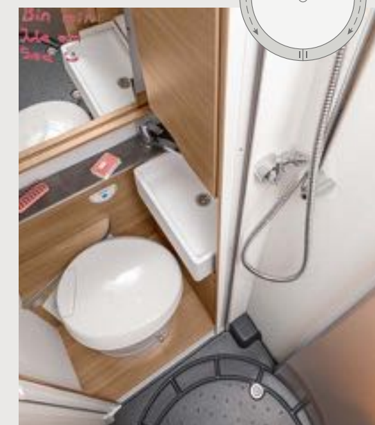
BOXLIFE 630 ME. Takket være forskyvningen av dusjkabinettet ut i gjennomgangen kan baderommet effektivt utvides. Slik gir det romslige baderommet maksimal plass til å bevege seg.
