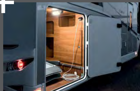
Belysning og 230 V stikkontakt i garasjen bak
