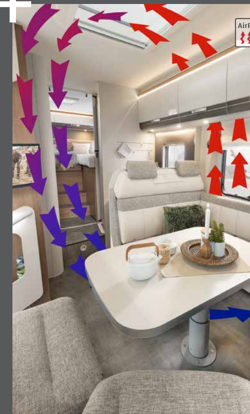
AirPlus-systemet forhindrer at det dannes kondensvann bak oveskapene
