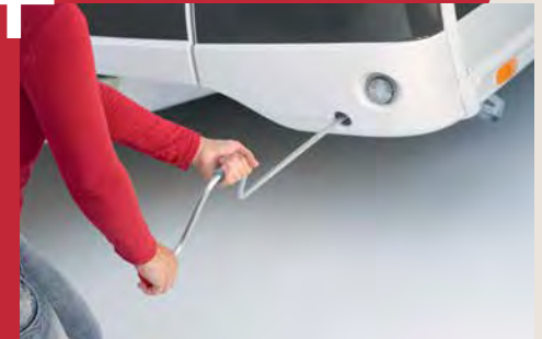
Sveiv-innføringshjelp for komfortabel betjening av støttebena
